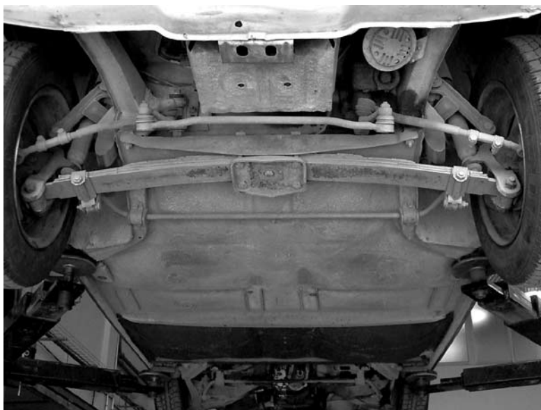
Ballestas dispuestas transversalmente en el eje delantero de un vehículo.
